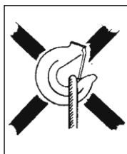
Fig 4 a Slinget belastar krokspetsen!
