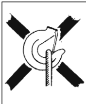
Kuva 4 a Silmukka kuormittaa koukun kärkeä!
