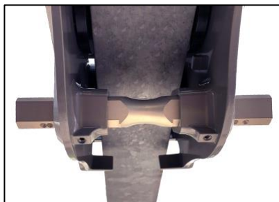
Fig. 5 Stoppeskruene hardt tiltrukket
