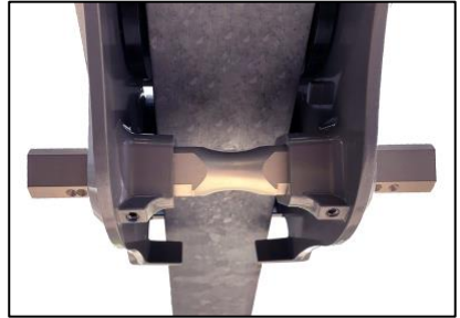
Fig 5 Stoppskruvarna hårt dragna
