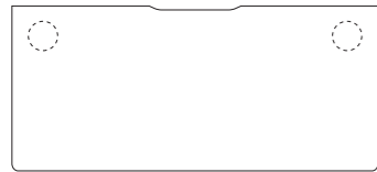
Bordsskiva 1000x450 mm, förborrade hål med diameter 80 mm för tillbehör
